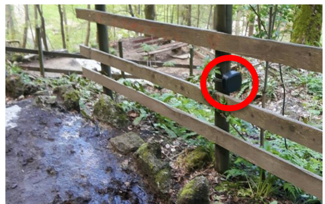
Abb. 2: Montagebeispiel: Die mobilen Besucherzählgeräte wurden an geeigneten Stellen in 80 cm Höhe entlang des Prädikatwanderweges angebracht.
