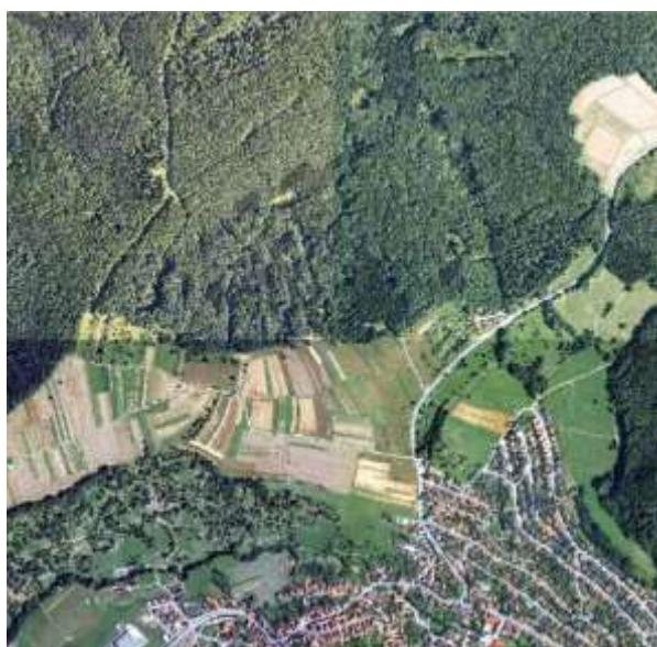
Abb. 7: Beleuchtungsunterschiede zwischen einzelnen Orthophotos (deutlich zu sehen ist die Aufhellung des linken oberen Bildes).
