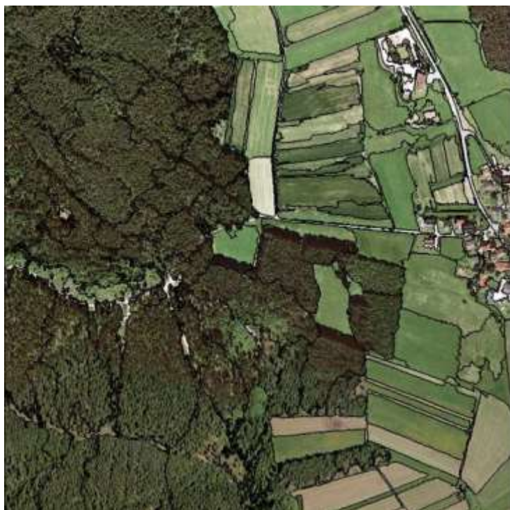
Abb. 15: Beispiel einer erfolgreichen Segmentierung eines RGB-Luftbildes mit einem scale parameter von 400 sowie einem shape parameter von 0,3 und einer compactness von 0,5.
